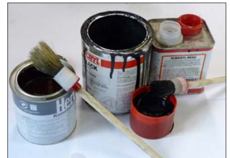
Alkydharz-Holzsigel transparent, Farblack mit Härterzusatz
